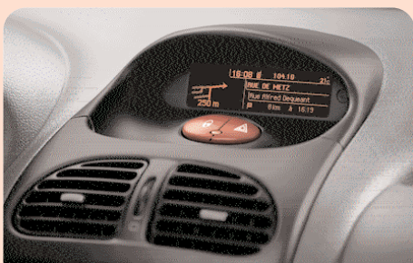
Mobiltelefon kijelzőjének megjelenítése a navigációs rendszer képernyőjén
